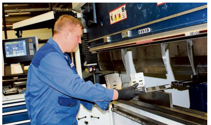
→ Mitarbeiter Witali Benke bei der Arbeit an der Abkantpresse Tru Bend 5130.
