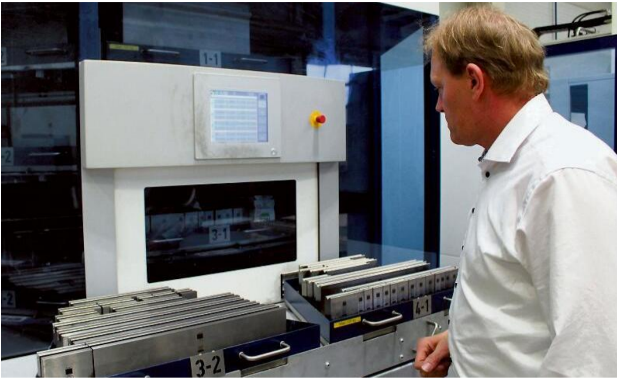
Das Tool-Shuttle bringt nach digitaler Aufforderung 160 verschiedene Werkzeuge an die Ausgabeöffnung (links). Schweißen ist nicht einfach, dafür benötigt man Fingerspitzengefühl. Doch Fabian Theinert (rechts) versteht sich in WIG- und MAG-Schweißen. „Er hat dafür ein Händchen“, sagt anerkennend sein Vater.
